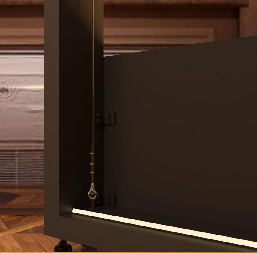
DETALHE FIXAÇÃO DO BANCO EXPOSITOR BE002 COM O PAINEL EP001
